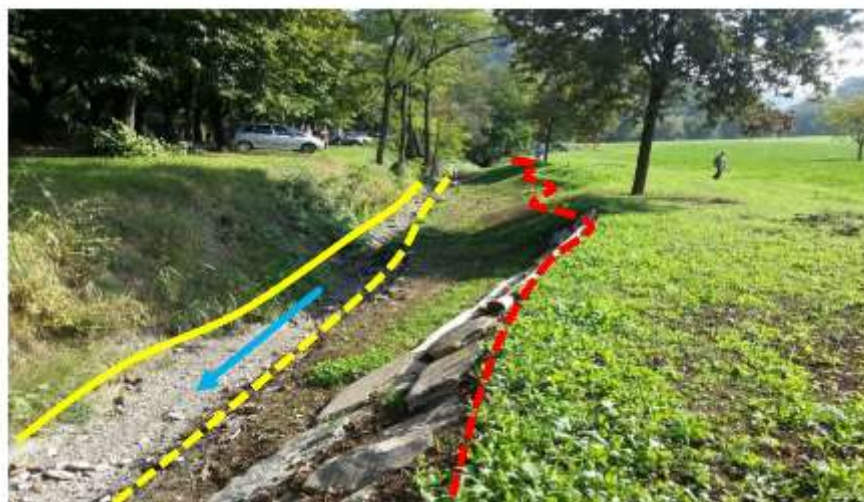
Sito di intervento durante il rilievo del 02/10/2014. In giallo continuo la sponda destra, in giallo tratteggiato la sponda sinistra pre intervento, in rosso la sponda sinistra arretrata.
